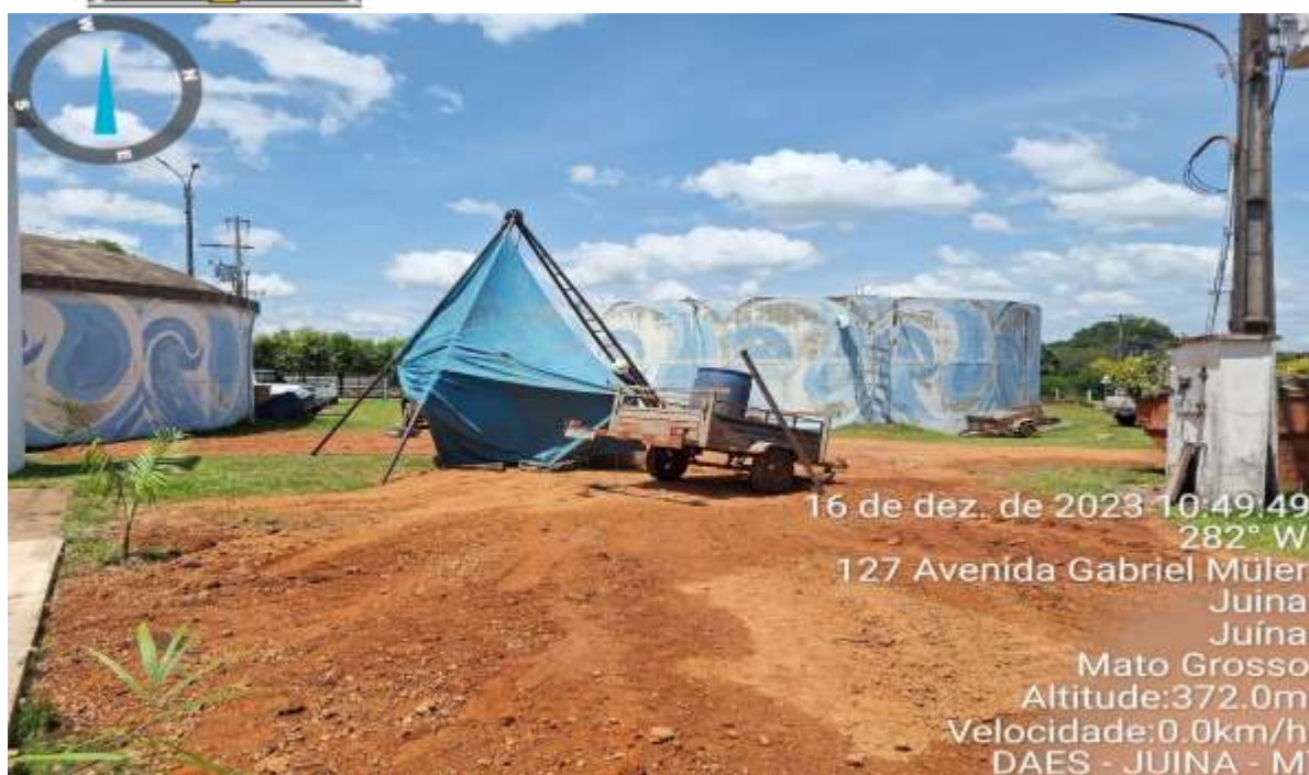
Figura3: Execução de Sondagem spt, área DAES, Cidade Juína – MT.
