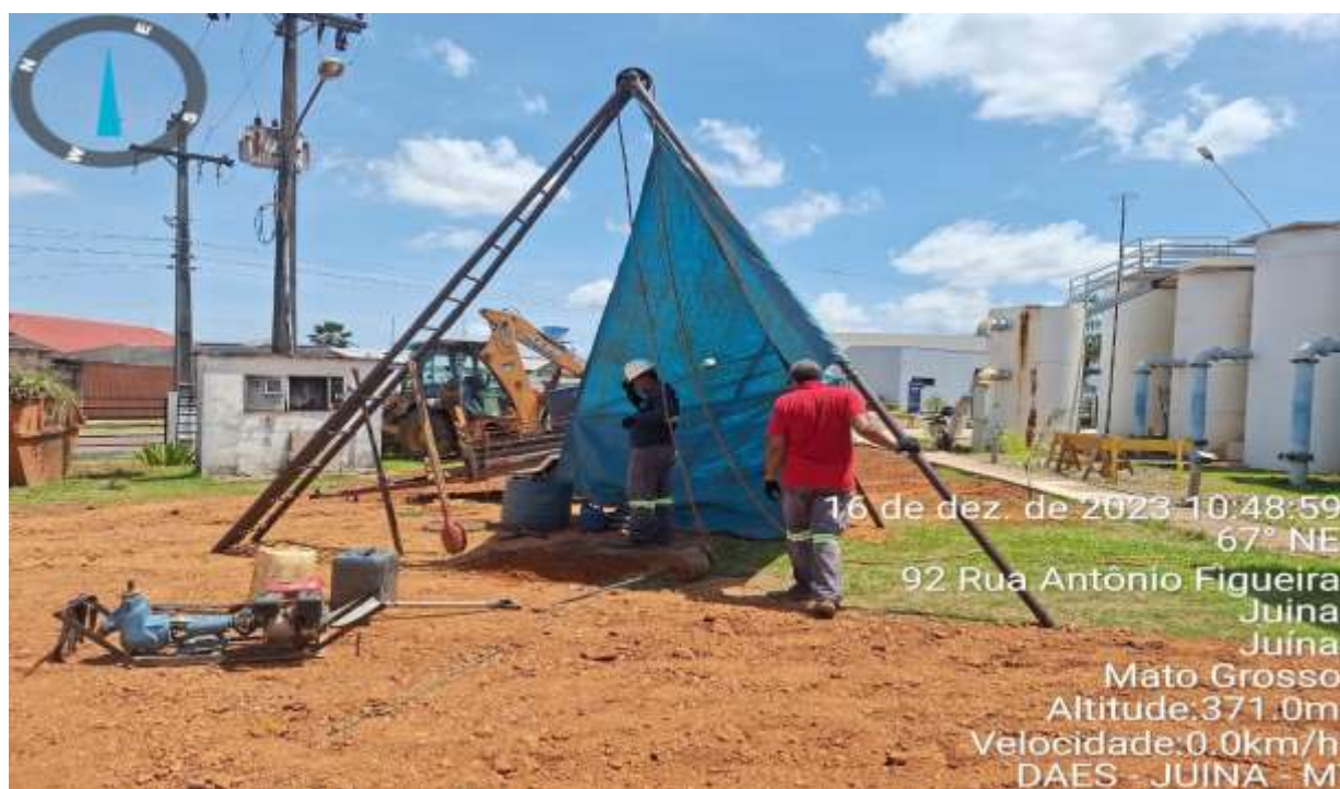
Figura 2: Sondagem a percussão spt, determinar as tensões admissível área DAES cidade Juína - MT.
