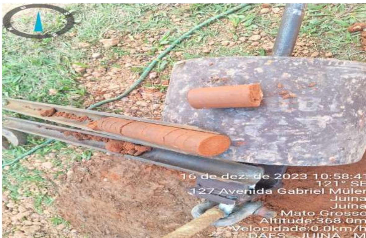
Figura 5: Amostra de solo, Sondagem a percussão spt, área DAES, Juína - MT.
